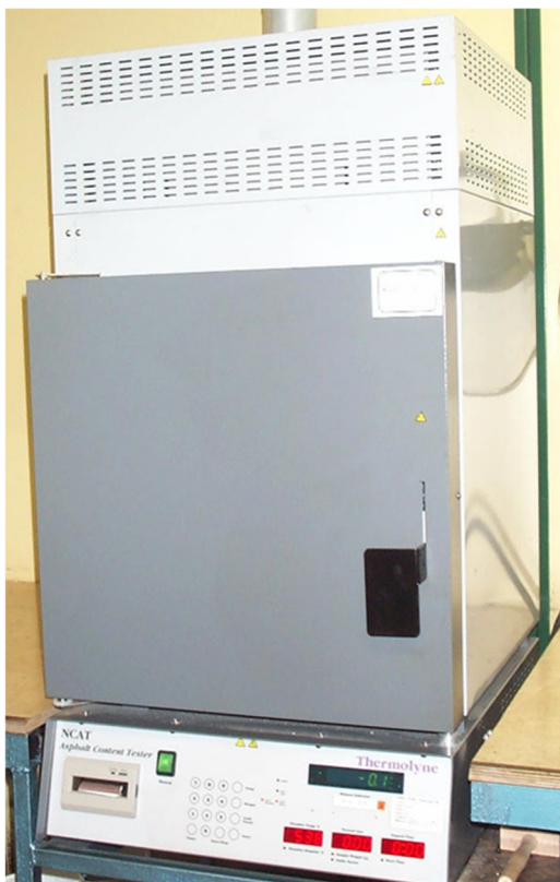
Bild 2. Förbränningsugn, från Thermolyne, för bestämning av bindemedelshalt i asfalt, på Skanskas tidigare laboratorium i Lomma.
