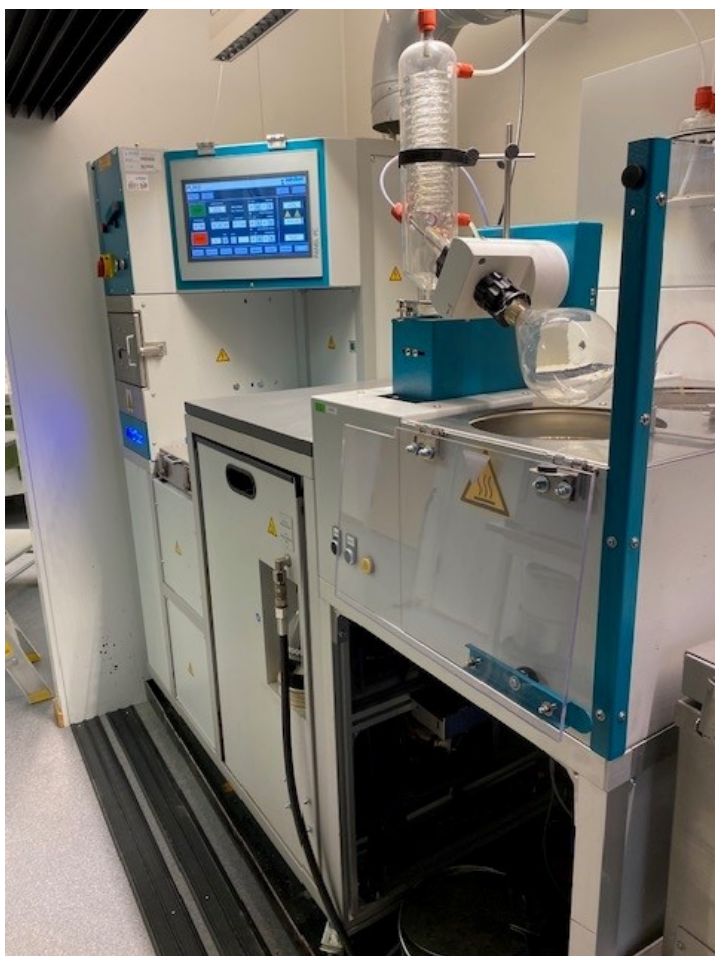
Bild 1. Asfaltanalysator med extraktions- och återvinningsenhet på Skanskas laboratorium i Gunnilse, från infraTest Prüftechnik GmbH.
